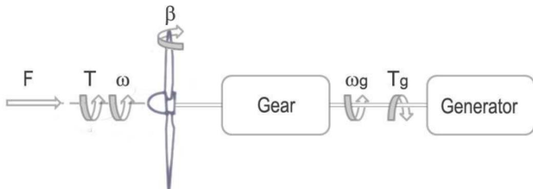
$T$  - rotor torque
