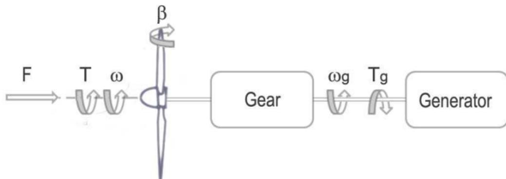
$T$  - rotor torque
